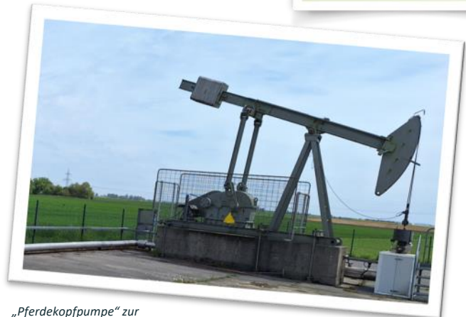
„Pferdekopfpumpe“ zur Erdölförderung bei Augsburg (Foto: Franz Hiemer)
