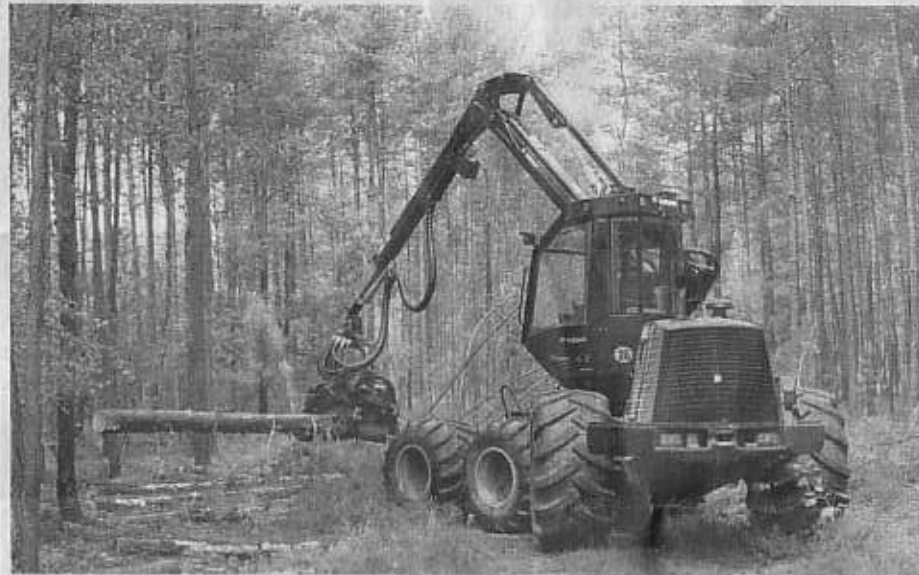
Ein Harvester erntet in Minutenschnelle ganze Bäume und macht sie transportbereit. Für diese Maschinen werden Schneisen in den Wald geschlagen.
