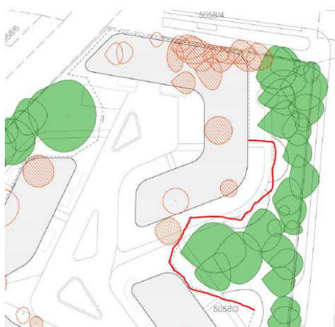
Seite 35, rot ist die kritische Tiefgaragenkante
