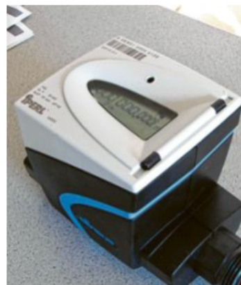
So sehen Wasserzähler aus, mit denen der Zählerstand per Funk ausgelesen werden kann. Foto: Gerald Modlinger
