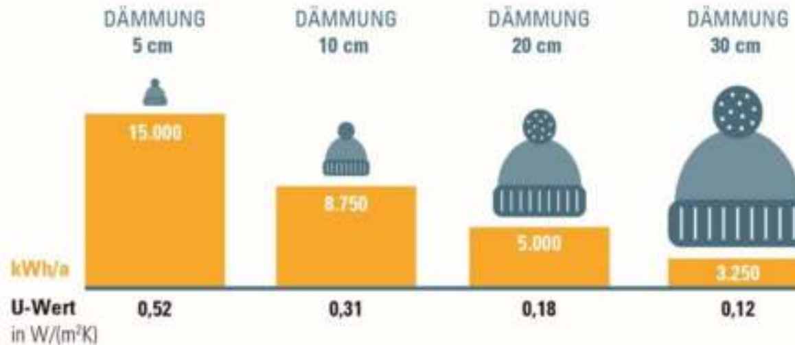
Wärmeverluste über die Außenwand eines Einfamilienhauses
