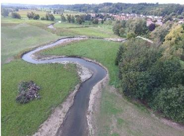
Drei neue Mäanderschlingen wurden angelegt, die sich durch die Kraft des Wassers dynamisch weiter entwickeln dürfen. Denn die Schmitter darf hier nun wieder fließen, nachdem ein ca. 40 cm hoher Spundwandabsturz ausgebaut wurde. Die Lauflänge der Schmitter konnte dadurch von ca. 700 m Länge auf ungefähr 1000 m Länge verlängert werden.
